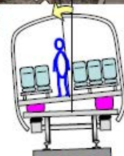
車体傾斜装置
