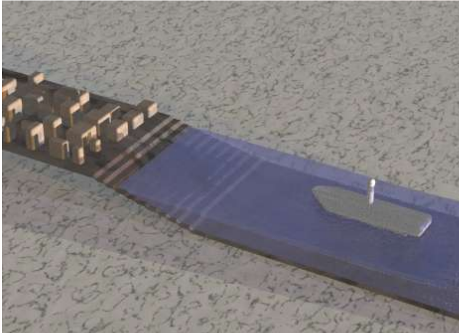
津波高さ10m: 船舶は変形破壊あり・地上構造物は剛体
