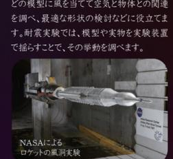
NASAによるロケットの風洞実験
